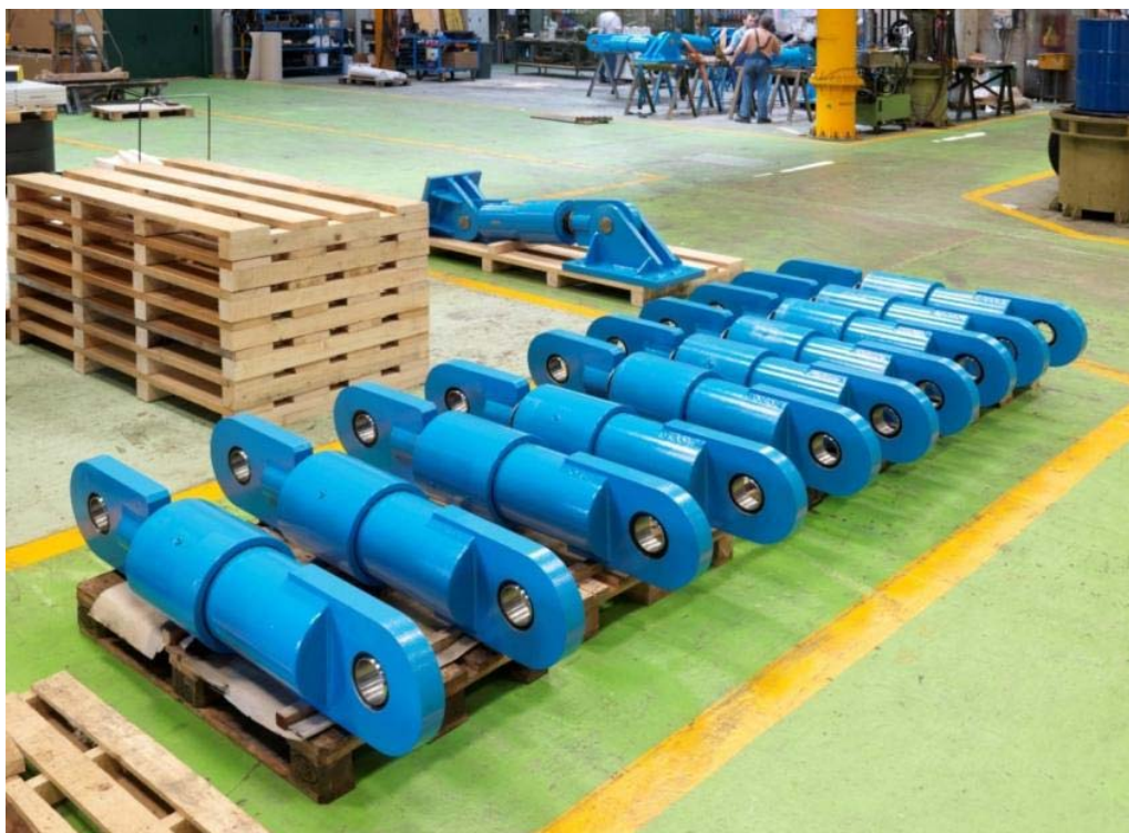
میراگرهای هیدرولیک (Viscous Dampers) براساس پارامترهای طرح و بصورت اختصاصی برای پروژه هتل بزرگ آزادی ساخته شده اند. کارخانه FIP Industriale در کشور ایتالیا.
