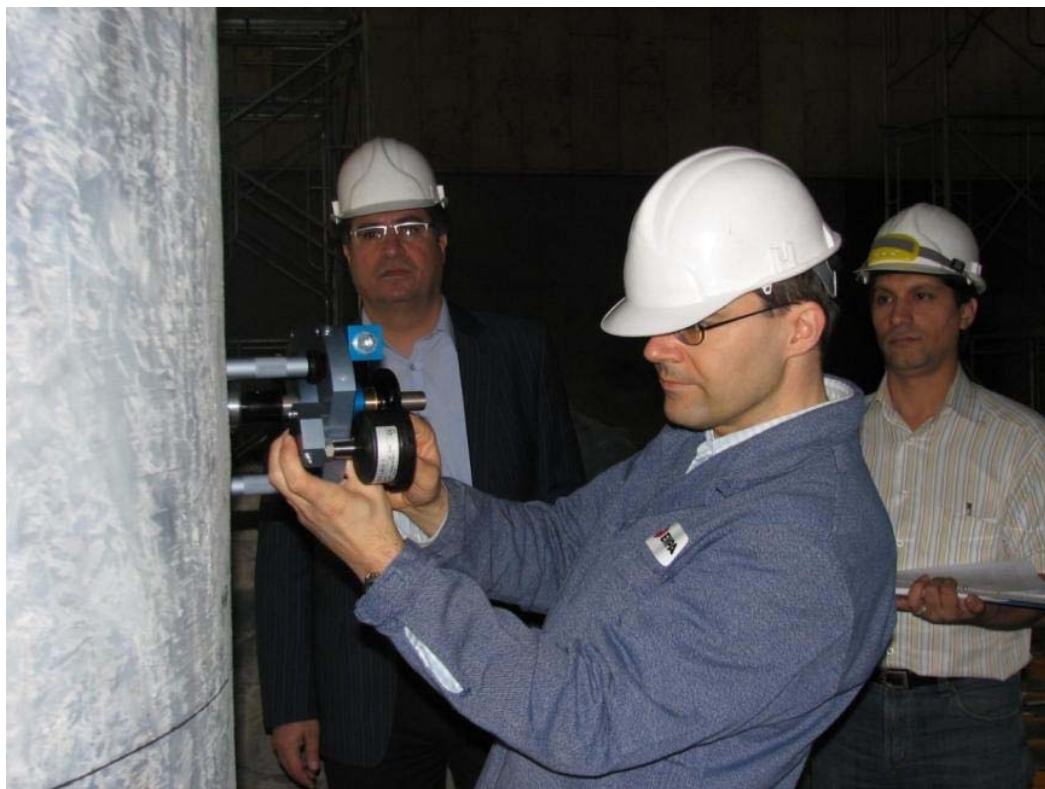
اجرای تست Pull off توسط کارشناس موسسه EMPA در هتل بزرگ آزادی تهران
