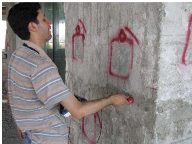
انجام تست غیرمخرب Ultrasound در نقاط مختلف برای ارزیابی تقریبی کیفیت بتن.
