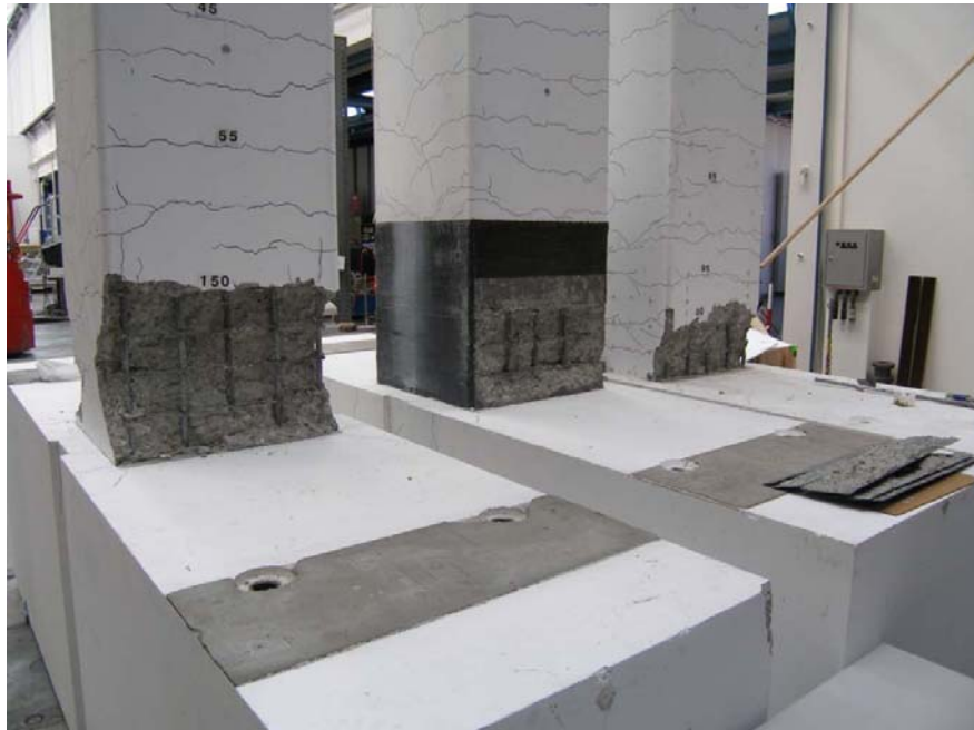
عکس شماره «۸»: در ستون میانی لایه CFRP قادر به جلوگیری از کمانش سه میلگرد فشاری نبوده
