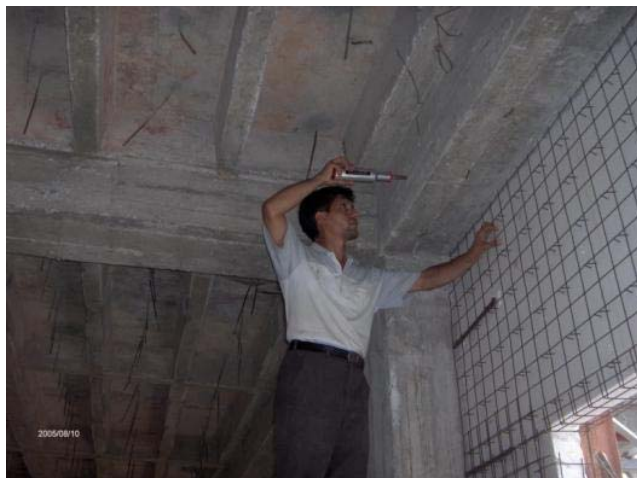
انجام تست غیر مخرب Schmidt Hammer در نقاط مختلف برای ارزیابی تقریبی مقاومت فشاری بتن.
