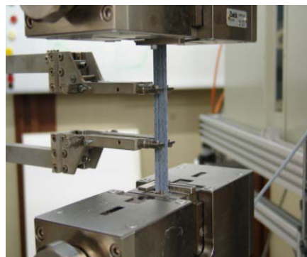
عکس «۱۵»: نمونه کامپوزیت FRP در حال تست کشش عکس «۱۶»: نمونه های کامپوزیت CFRP پس از تست کشش
