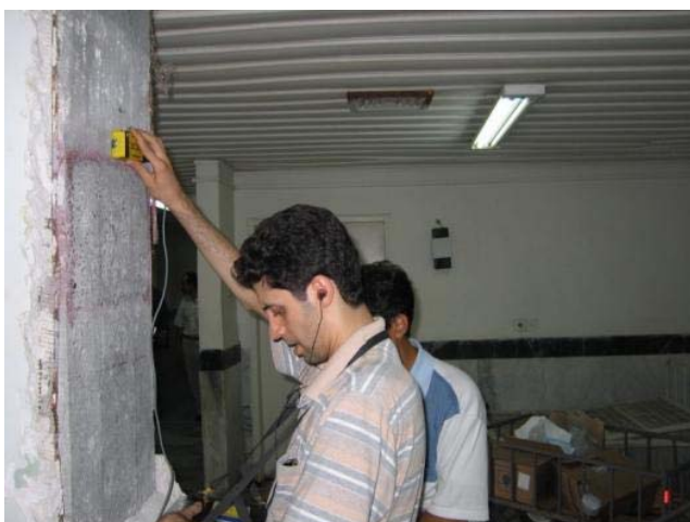
انجام تست غیرمخرب Ultrasound در نقاط مختلف برای ارزیابی تقریبی کیفیت بتن.
