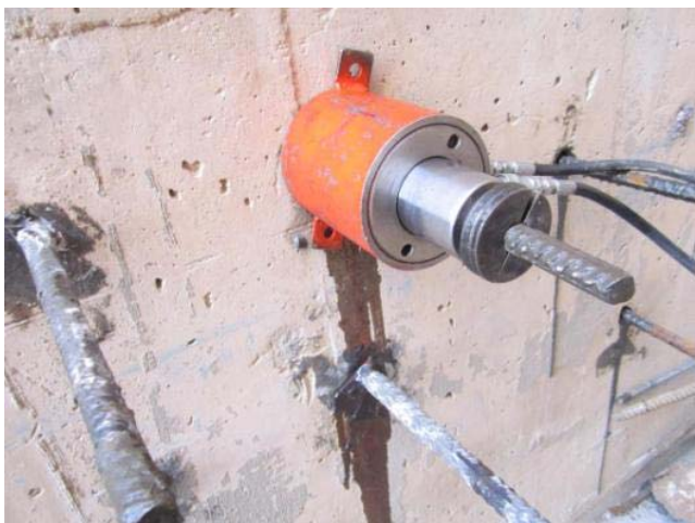
تست بیرون کشیدگی توسط جک هیدرولیکی جهت آزمایش مقاومت کششی رزین های بکار رفته
