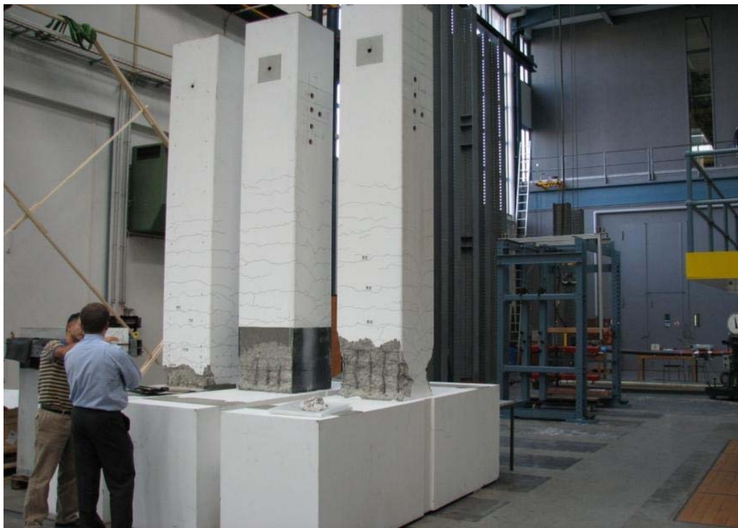
سه عدد از نمونه های ستونهای هتل آزادی پس از تست بارگذاری جانبی- موسسه EMPA سوئیس.
