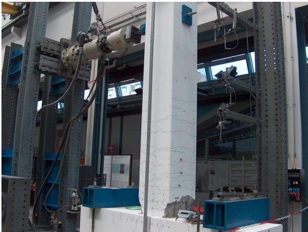
شبیه سازی بارگذاری زلزله بر روی نمونه های مشابه ستونهای هتل آزادی در موسسه EMPA سوئیس.
