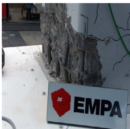
عکس شماره «۷»: کمانش موضعی میلگردهای فشاری در ستون نمونه بدون تقویت برای مقایسه
