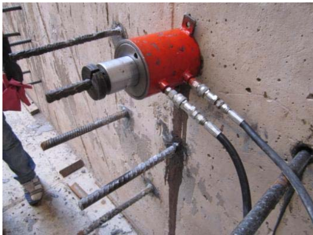
تست بیرون کشیدگی توسط جک هیدرولیکی جهت آزمایش مقاومت کششی رزین های بکار رفته
