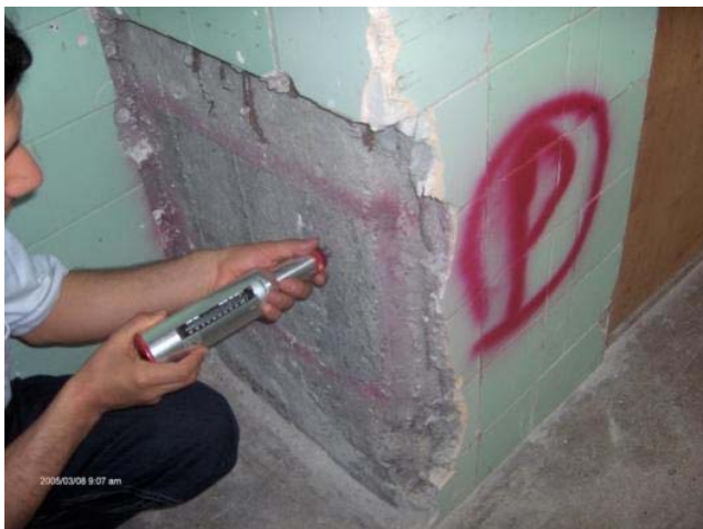
انجام تست غیر مخرب Schmidt Hammer در نقاط مختلف برای ارزیابی تقریبی مقاومت فشاری بتن.
