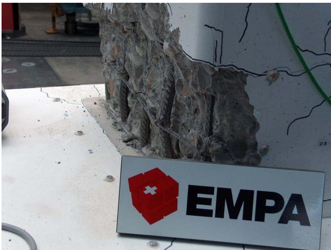
کمانش موضعی میلگردهای طولی ستون در اثر بارگذاری متناوب جانبی - موسسه EMPA سوئیس.
